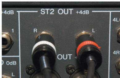
Das Kabel schließen Sie entweder über zwei Monoklinken- oder zwei XLR-Anschlüsse an das Mischpult an. Es gibt sowohl Adapter „XLR auf Klinke“ als auch „Klinke auf XLR“. Sie brauchen auf jeden Fall ein Y-Kabel, das auf der einen Seite mit Ihrer Kamera und auf der anderen mit dem Mischpult verbunden ist.
