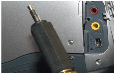
Der Eingang der Kamera ist in der Regel ein Miniklinken-Eingang und wird als Line-In oder MIC bezeichnet.
